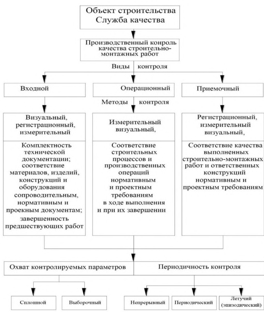
Рисунок 1. Общая схема производственного контроля качества строительно-монтажных работ
